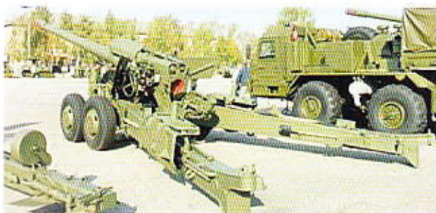
В конструкции пушки использован горизонтальный клиновой затвор с полуавтоматикой скользящего типа. Он обеспечивает скорострельность до 6 выстрелов в минуту. Процесс заряжания упрощен благодаря наличию досыпателя, приводимого в действие гидропневматическим аккумулятором.
